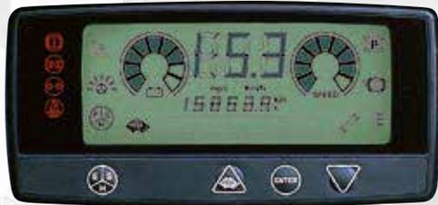
La combinación de pantallas LED y pantalla LCD gráfica de 7 dígitos proporciona de forma inteligente a los operadores todos los detalles que necesitan, incluida la información operativa, los diagnósticos y las configuraciones programables. Los 4 botones de pantalla ofrecen una opción de cuatro modos de energía; modo de servicio pesado, servicio estándar, servicio económico y velocidad de desplazamiento lenta. Las imágenes de instrumentos estándar se muestran a la derecha.
