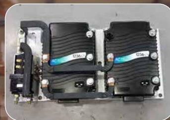
Motor de bomba y accionamiento cerrado
